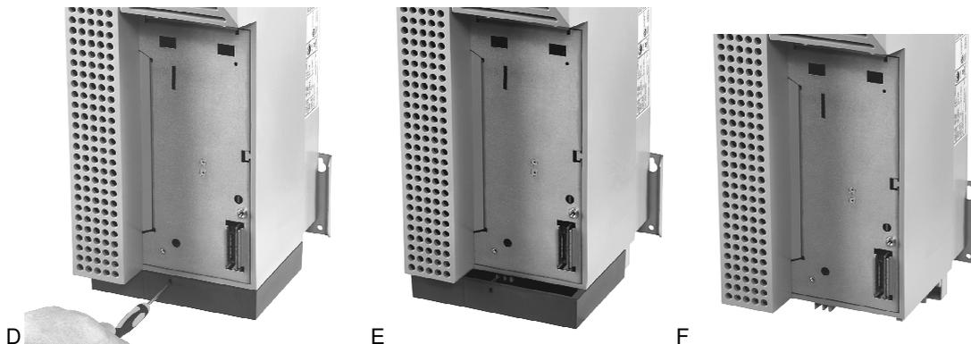
1. Verwenden Sie einen schmalen langen Schraubendreher (ca. 2mm Durchmesser) und stecken Sie diesen ca. 15 mm tief in die vorgesehene Öffnung an der unteren Klemmenabdeckung (D).
